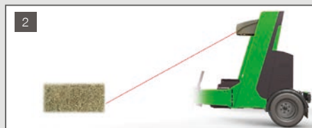
2 EL SENSOR DE LÁSER DETECTA LA PACA.
