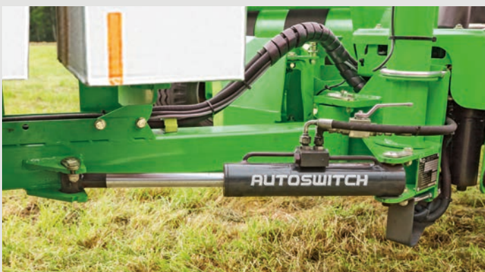
FUNCIÓN AUTOSWITCH, CAMBIO FÁCIL DE LA POSICIÓN DE TRABAJO O LA POSICIÓN DE TRANSPORTE
