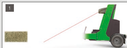
1 EL SENSOR DE LÁSER MIDE LA DISTANCIA CON RESPECTO AL SUELO.
