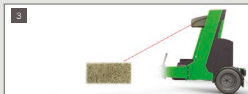
3 EL SENSOR DE LÁSER DETECTA EL EXTREMO DE LA PACA. SE COMIENZA A MEDIR LA LONGITUD DE LA PACA CONTANDO LOS IMPULSOS DEL SENSOR DE LA RUEDA. LOS BRAZOS DE CARGA ADOPTAN LA POSICIÓN DE PRECARGA (BASADA EN UNA ANCHURA DE PACA PREDEFINIDA)
