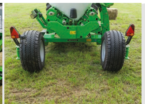
DURANTE EL TRANSPORTE POR CARRETERA, LAS RUEDAS SE PUEDEN PLEGAR HACIA DENTRO A FIN DE REDUCIR LA ANCHURA DE TRANSPORTE. LA FUNCIÓN DE REPLIEGUE HIDRÁULICO ES OPCIONAL.
