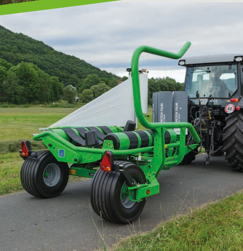
LA ANCHURA DE TRANSPORTE ES REDUCIDA GRACIAS A LAS RUEDAS DE POSICIÓN AJUSTABLE.
