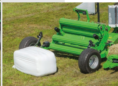
LA ESCASA ALTURA DE LA MESA PERMITE DEPOSITAR SUAVEMENTE LA PACA PARA EVITAR EL DETERIORO DEL PLÁSTICO.
