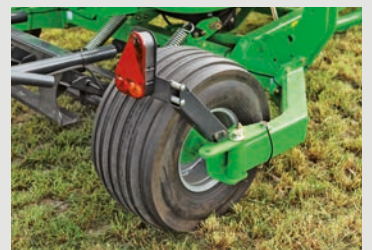
LA RUEDA DERECHA SE PLIEGA HACIA EL INTERIOR PARA EL TRANSPORTE POR CARRETERA. EL PLEGADO EN EL LADO IZQUIERDO ES OPCIONAL
