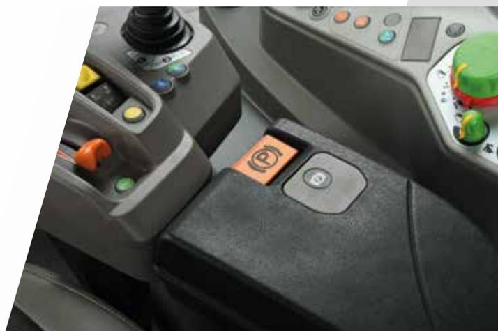
> Freno di stazionamento elettronico (EPB) sui modelli RVshift e TTV.
