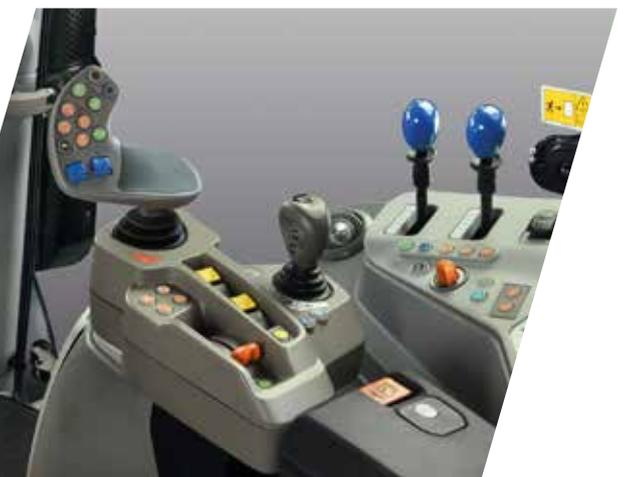
> Sui modelli con trasmissione RCshift, per il comando dei distributori posteriori è possibile usare i potenziometri del joystick MaxCom e due leve di comando, mentre per il caricatore frontale si può usare la leva a croce.
