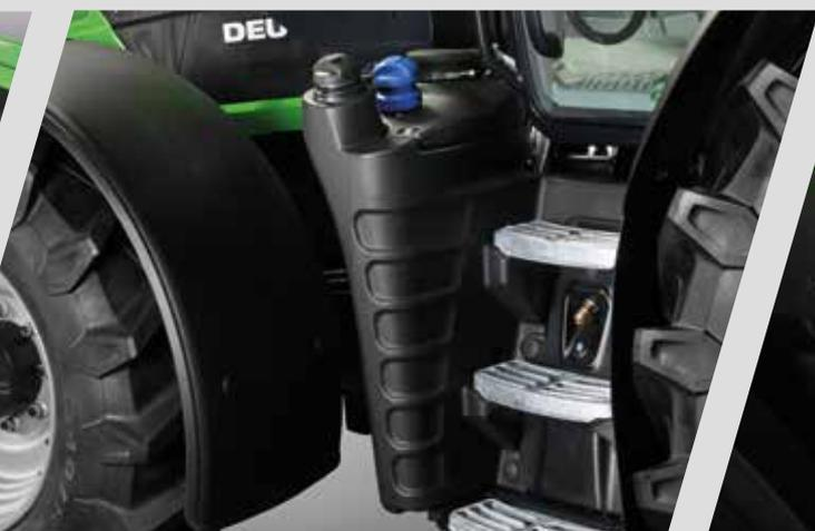
> Grande serbatoio carburante, attacco per aria compressa e interruttore per luce di accesso tra i gradini per un'accessibilità ottimale.
