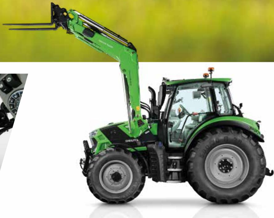
> I nuovi caricatori frontali Profiline raggruppano tutte le tubazioni idrauliche all'interno della traversa per la loro massima protezione e per offrire al conducente una visuale senza ostacoli.
