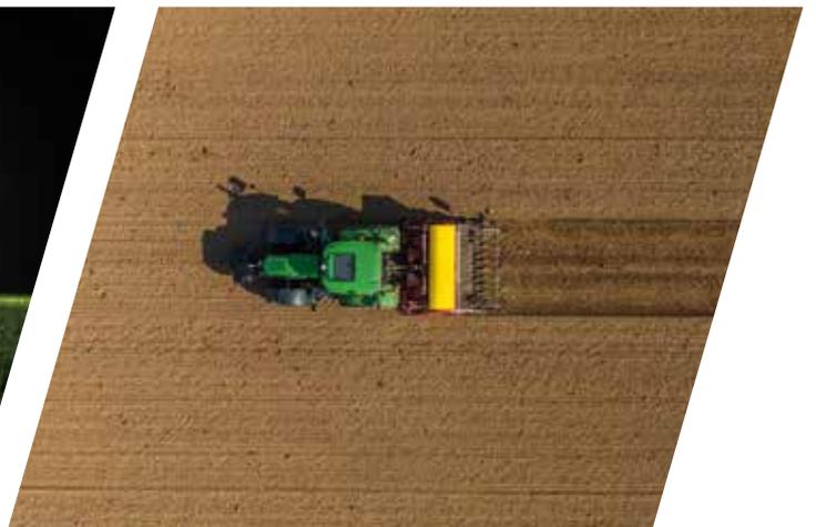
> La funzione SDF Guidance, in combinazione con ComforTip<sup>pro</sup> e AUTO-TURN, assicura che il trattore operi in modo completamente automatico, gestendo tutte le operazioni in campo e a fine campo sulla base di confini predefiniti. Questo sistema alleggerisce il conducente e garantisce il massimo comfort.
