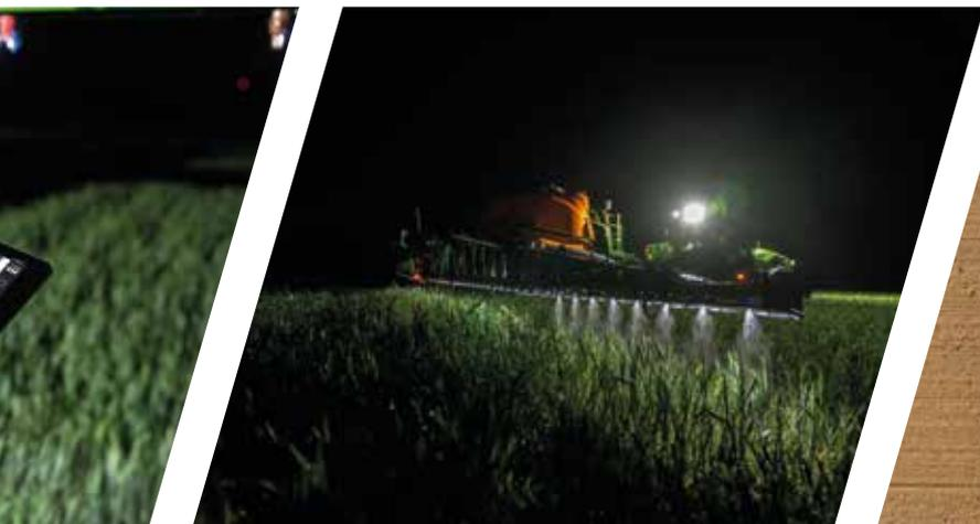
> Il controllo automatico delle sezioni e un'irroratrice con controllo sul singolo ugello consentono di risparmiare fitofarmaci. Il controllo automatico delle sezioni con un massimo di 255 sezioni è previsto di serie su tutti gli iMonitor.
