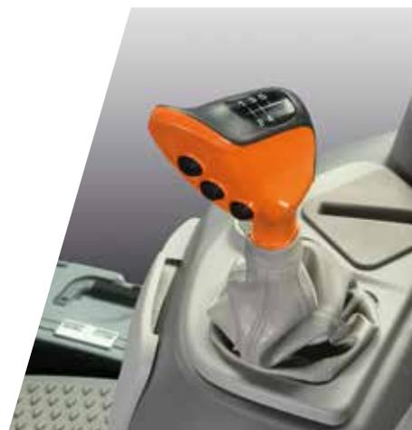
> Ergonomica leva del cambio con pulsanti per ComfortClutch, APS e Powershift.
