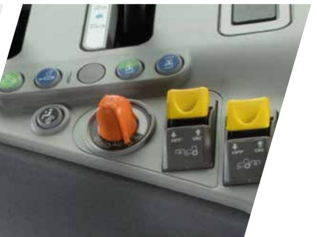
> Uso facile e intuitivo – con la manopola di regolazione ECO/Power l'operatore può modificare la modalità di innesto dell'APS (Automatic Powershift).
