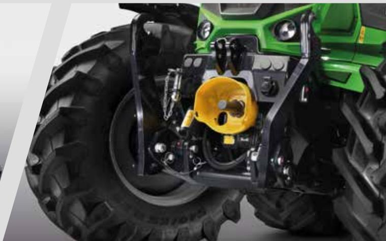
> Il robusto sollevatore anteriore con capacità di sollevamento di 3000 kg e PTO anteriore integrata disponibile sui modelli 6130.4 - 6150.4.
