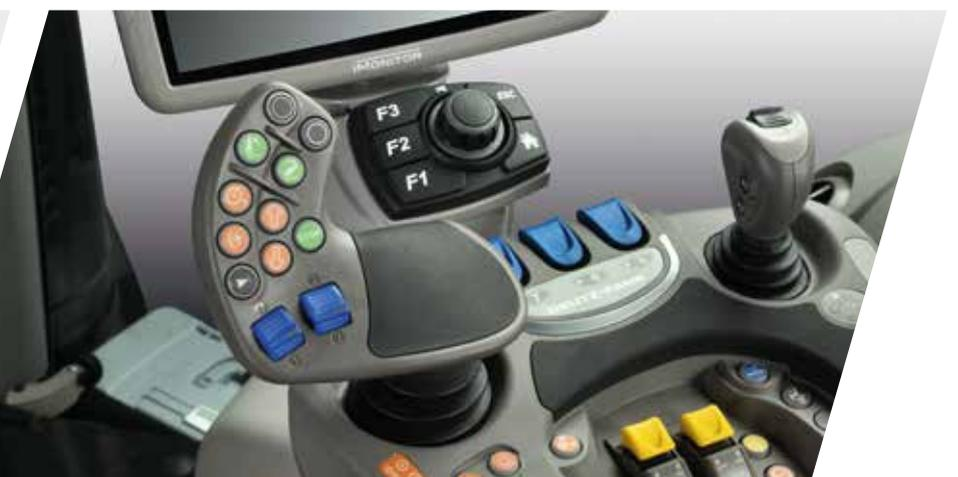
> Per il controllo dei distributori elettronici, l'operatore può scegliere tra i comandi "fingertip" blu, il piccolo joystick o i pratici potenziometri del joystick MaxCom.
