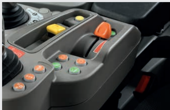
↑ Acceleratore manuale elettronico con due regimi motore memorizzati.
