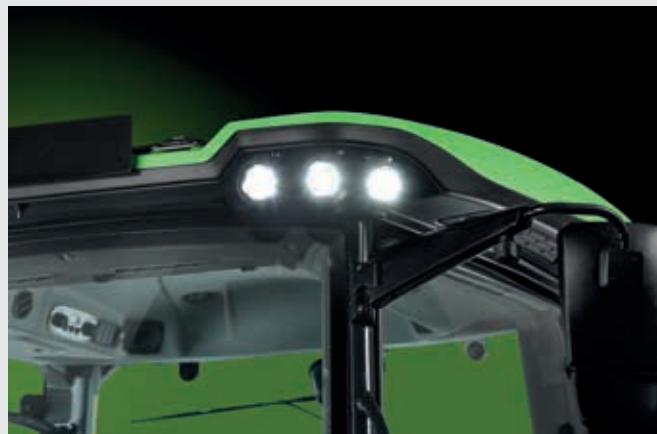
↑ Fino a 12 fari a LED nel tetto della cabina.
