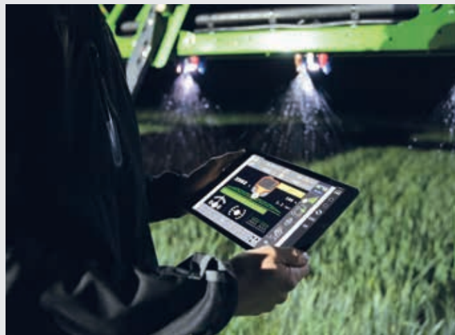
↑ Funzione XTEND con tablet, comando delle attrezzature tramite ISOBUS UT dall'esterno della cabina.
