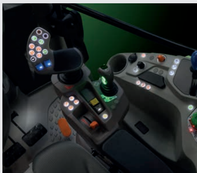
↑ L'apprezzatissimo joystick MaxCom previsto sulle versioni TTV è un concentrato di alta tecnologia che permette all'operatore di controllare con la massima comodità tutte le principali funzioni della macchina con una sola mano.
