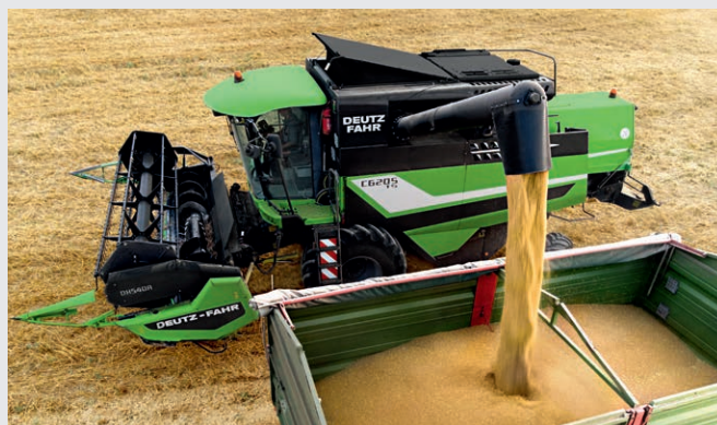
↑ Tubo di scarico per scaricare la granella durante il lavoro in qualsiasi posizione anche con rimorchi a sponde alte.
