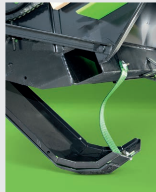
↑ Slitte tastatrici affidabili e robuste per il sistema Autocontrol.
