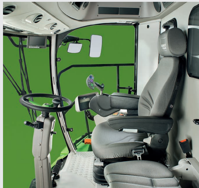
La cabina Commander Cab EVO II con secondo sedile.
