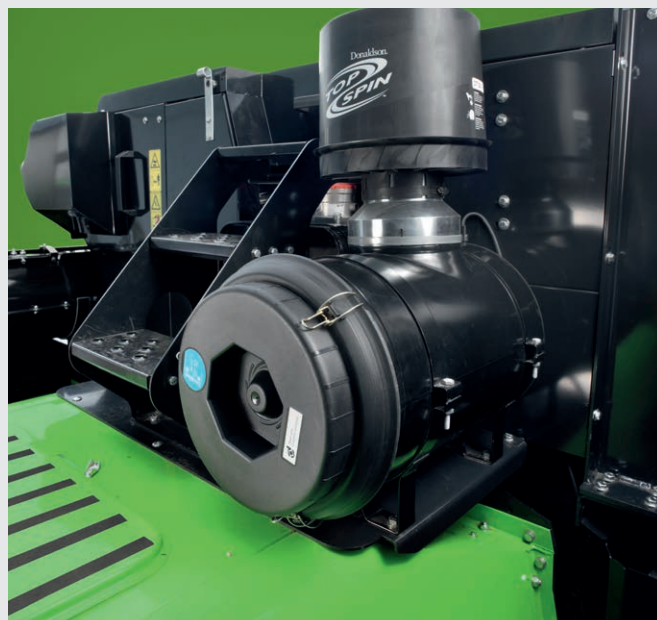
↑ Filtro aria autopulente ad alte prestazioni per lavorare in qualsiasi condizione.
