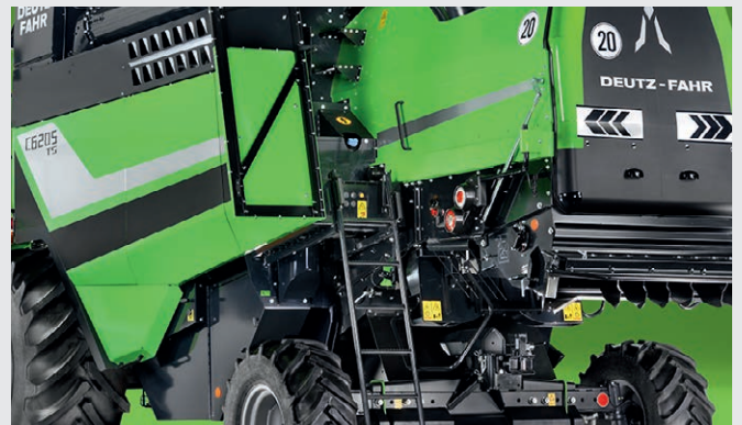
↑ Facile accesso anche alla parte superiore della mietitrebbia per i rifornimenti di gasolio e AdBlue.
