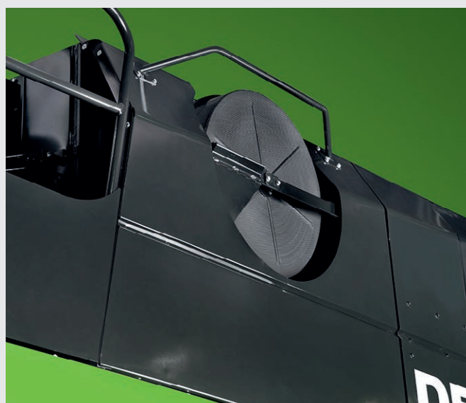
↑ Grandi filtri rotanti per garantire la massima efficienza dell'impianto di raffreddamento.
