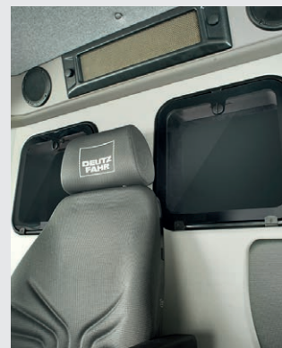
↑ Doppia finestrella di ispezione del serbatoio granella.
