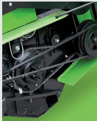
↑ Trasmissione planetaria per un'alta frequenza di taglio.
